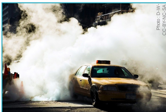
Dégagements de vapeur à Manhattan Presque aussi connus que les taxis jaunes New-Yorkais, les nuages de vapeur qui s'échappent des rues et des trottoirs ne proviennent en général pas du réseau de chaleur lui-même, mais d'infiltrations souterraines d'eau qui s'évapore au contact des conduites.
